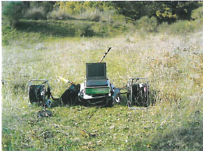
Foto 2 - Sismografo 24 canali Ambrogeo mod. Echo 24/2002 Seismic UNIT.
