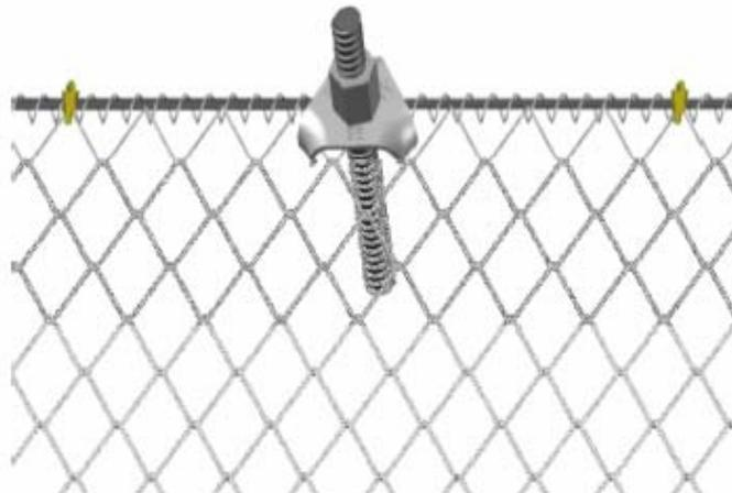
Ai bordi della rete nella zona perimetrale superiore e inferiore il collegamento tra rete e funi perimetrali superiore e inferiore di diametro 18 mm dovrà essere eseguita mediante una fune secondaria di diametro 6 mm che viene tessuta secondo lo schema sotto riportato, conforme a quanto indicato negli elaborati progettuali (Tav. n°20).
